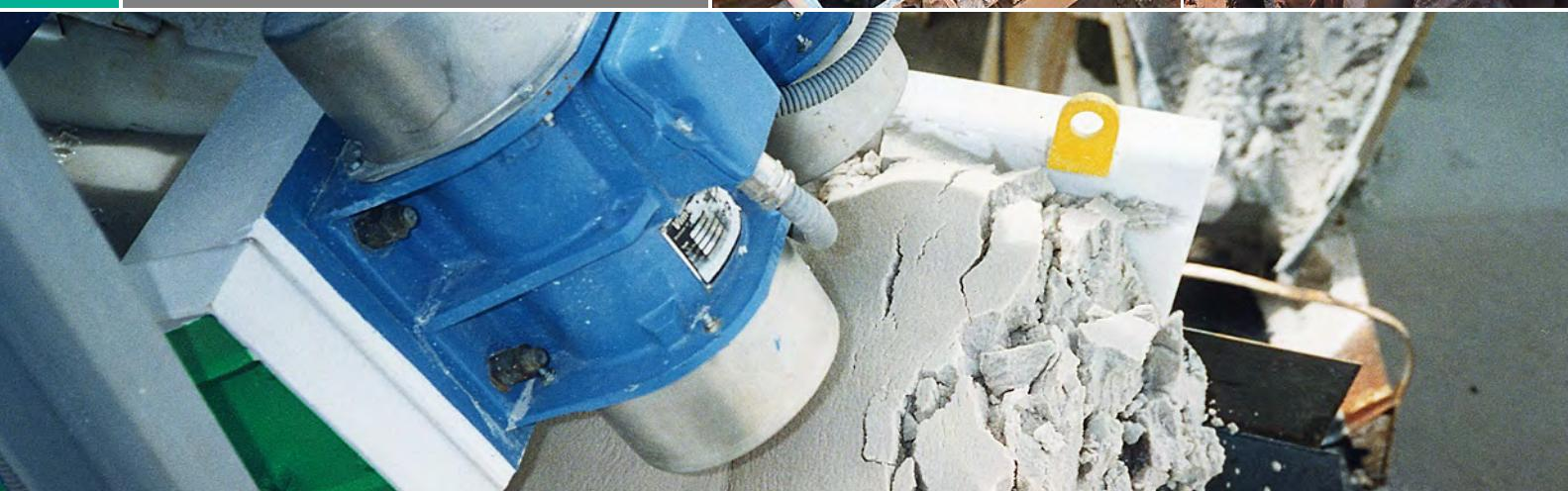
Los **Escurridores Vibroflux** permiten reducir el contenido de agua de las arenas a valores mínimos, según la naturaleza del material procesado y su coeficiente de absorción de agua o grado de saturación. **AMP** ofrece una amplia gama de modelos capaces de cumplir con las mayores expectativas de calidad en el producto final por parte de los usuarios.
