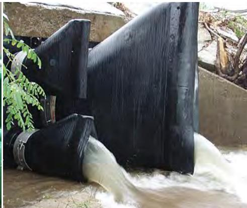
Válvula "tipo pinch" en mina de cobre
