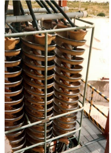
Fig. 6 – Espirales concentradoras. Eliminación de contaminantes
